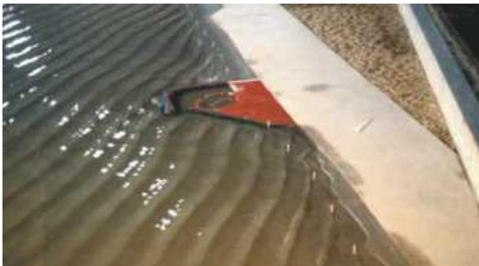
**Figura 3.3.6:** L'adozione di scale distorte consente, in generale, una buona riproduzione dei fenomeni di rifrazione del moto ondoso, risultando, invece, più carente per riflessione e diffrazione, tuttavia tale limitazione non riveste normalmente importanza determinante ai fini dello studio del movimento del materiale di fondo. (ESTRAMED s.p.a., 1990).
