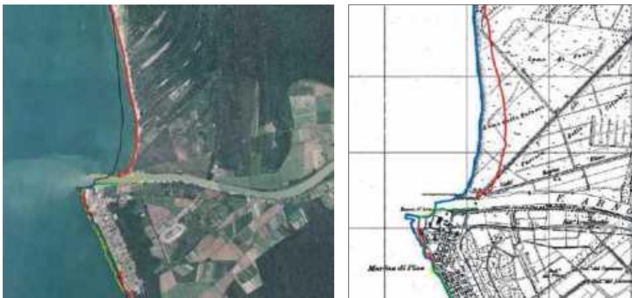
**Figura 3.1.1:** La sovrapposizione dei profili del litorale toscano in prossimità della foce del Fiume Arno rilevati negli anni '50 (carta IGM, scala 1:25.000, anno 1950) e nel 1998 (ortofoto VOLOIT2000) mostra la tendenza all'arretramento della linea di riva.
