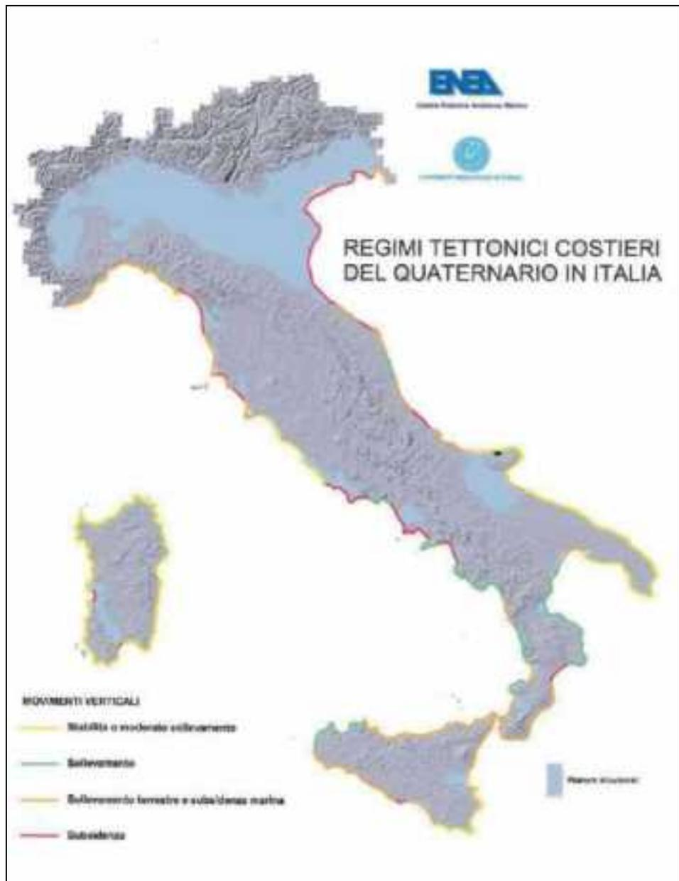
**Figura 2.1.6:** Pianure alluvionali (aree colorate in azzurro) e tratti di costa interessati dal fenomeno della subsidenza (in rosso). Enea S. Teresa e Università di Parma, Elementi di gestione costiera, parte II: "Erosione Costiera Lo stato dei litorali italiani"
