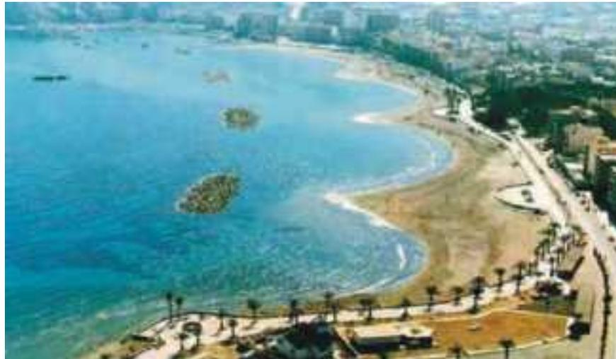
**Figura 4.4.20:** Bozza del progetto di una spiaggia artificiale protetta con pennelli e barriera soffolta a Marina di Pisa. (Foto BeachMed).
