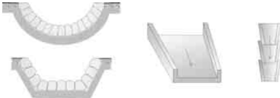
**Fossi di guardia:** sono realizzanti eseguendo scavi con sezione ad U o trapezoidale, immediatamente a monte della nicchia di distacco in modo da intercettare le acque correnti superficiali lungo il versante ed allontanarle dall'area instabile. Lo scavo ha, in genere, un rivestimento rigido in calcestruzzo.
