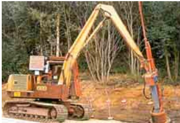
La tecnologia della chiodatura dinamica del terreno viene utilizzata soprattutto negli interventi di stabilizzazione e consolidamento di pendii instabili o di scarpate artificiali.
