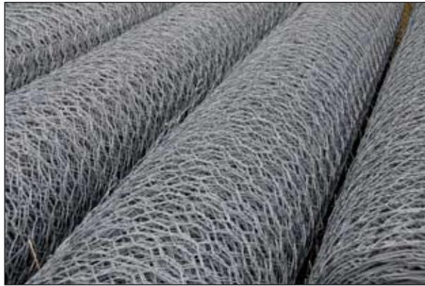
Le reti metalliche sono materiali artificiali molto versatili utilizzati frequentemente in abbinamento con tutti gli altri tipi di materiali: rotoli di rete metallica a doppia torsione zincata (Foto R.Ferrari).
