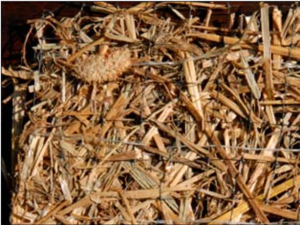
Biofeltro in fibre di paglia contenuto da rete in materiale sintetico degradabile (recto) (Foto R.Ferrari).
