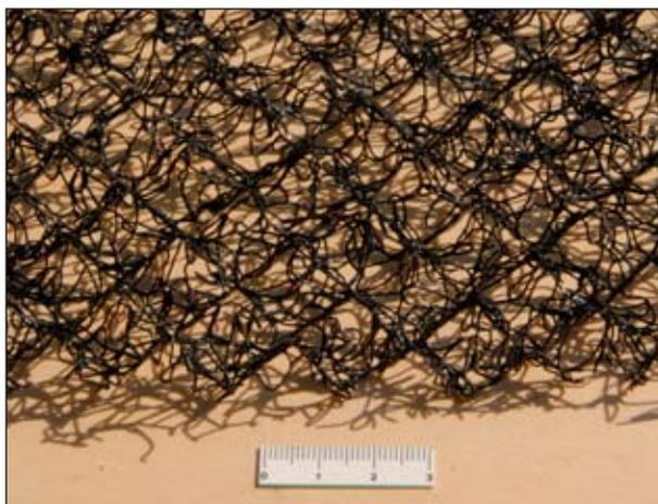
**Georete tridimensionale in fibre sintetiche (Foto R.Ferrari).**
