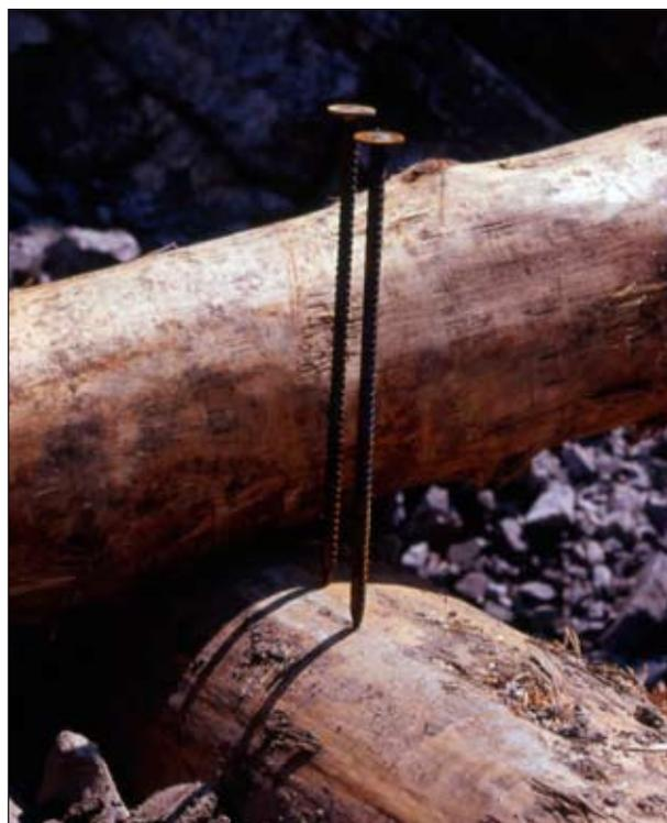
Chiodi (segmenti) in tondino di ferro ad aderenza migliorata con testa e con punta: possibile utilizzo, a seconda del tipo, in tutte le tipologie di interventi combinati di consolidamento che implicano l'impiego ed il fissaggio reciproco di tronchi (Foto R.Ferrari).
