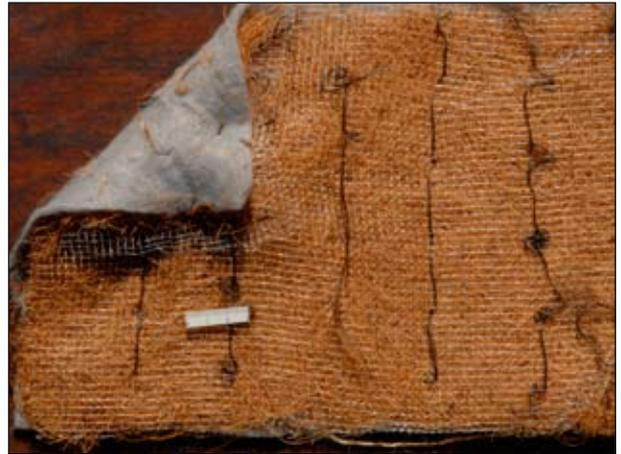
Biofeltro in fibre di cocco contenuto da rete in materiale sintetico degradabile (recto) e biofeltro sintetico (verso) (Foto R.Ferrari).
