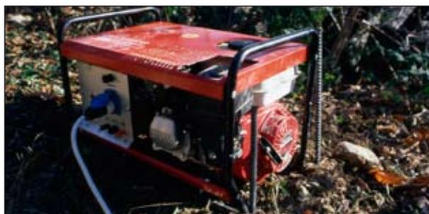
Generatore elettrico portatile di piccole dimensioni di potenza sufficiente per un'attrezzatura di base (Foto R.Ferrari).
