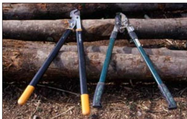
Cesoie a manici lunghi comunemente utilizzate nelle fasi di raccolta, preparazione e manutenzione del materiale vegetale vivo (talee s.l.) (Foto R.Ferrari).
