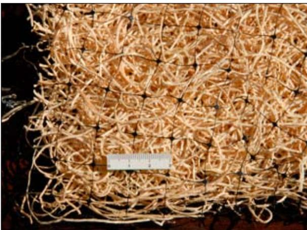
Biofeltro in fibre di legno contenuto da rete in materiale sintetico degradabile (recto) (Foto R.Ferrari).
