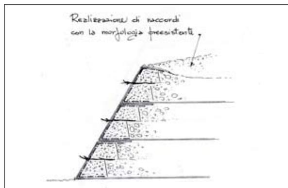
Terra rinforzata rinverdata in griglia ed armatura metallica (sezione) (Disegno E.Ferrari).
