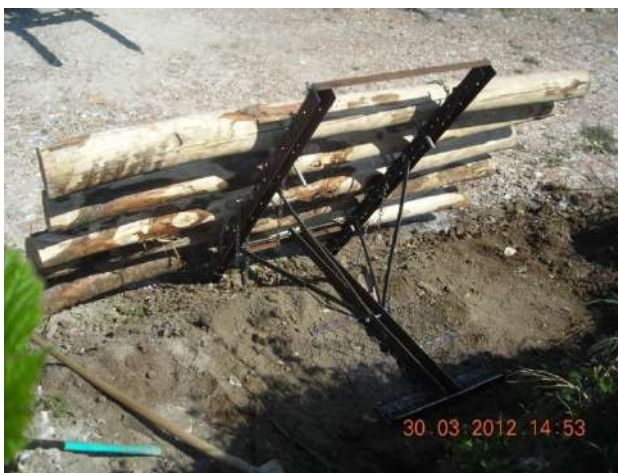
Foto 694 e Foto 695: Prove di carico su loricata. Area sperimentale Pavona (RM). Foto E. Marrone
