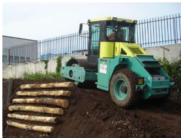
Foto 694 e Foto 695: Prove di carico su loricata. Area sperimentale Pavona (RM). Foto E. Marrone
