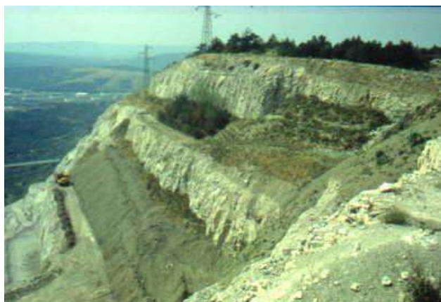
Foto 375: Ricomposizione morfologica su cava a gradoni Cava Scoria (TS), 1998 Foto: G. Sauli
