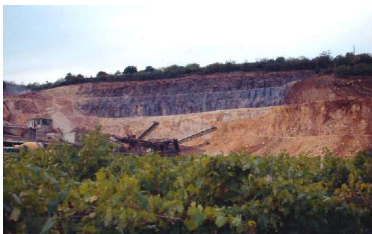
Foto 371: Intervento di inscurimento con sostanze ossidanti, cava San Lorenzo, Soave (VR), 1993 Foto: G. Sauli
