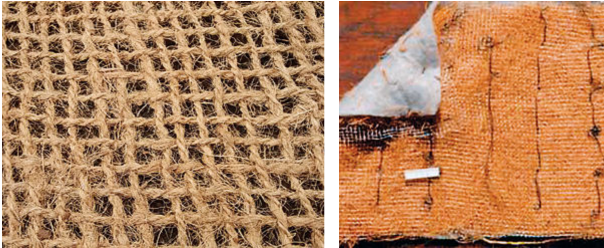
Malla orgánica y manta orgánica. Fuente: P. Sangalli
