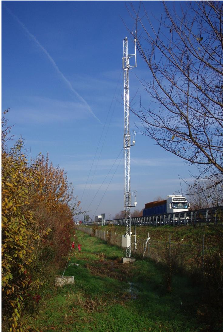
Rilevazione sperimentale della turbolenza meccanica che si sviluppa attorno alla barriera.
