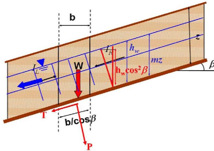
Figura 121 - Schema del pendio infinito.
