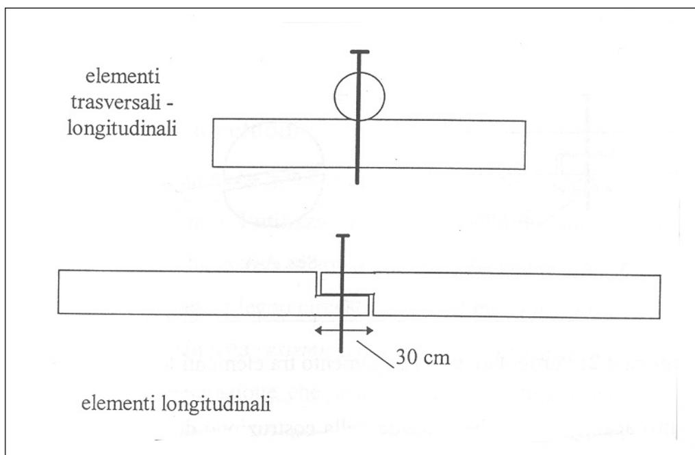
Figura 43 - Collegamenti tra i vari elementi della struttura.
