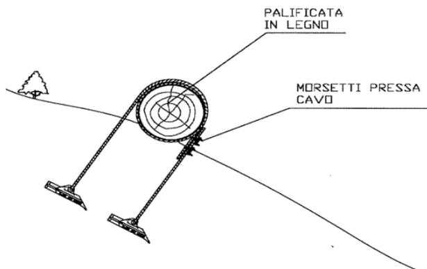
Figura 130 - Sistema di ancoraggio - vista: elementi.
