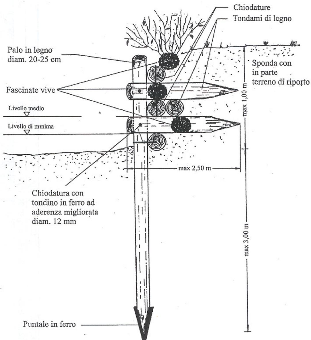
Figura 101 - Palificata spondale con palo verticale frontale - sezione.
