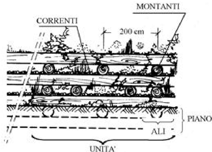
Figura 93 - Palificata viva di sostegno a parete doppia - vista elementi.
