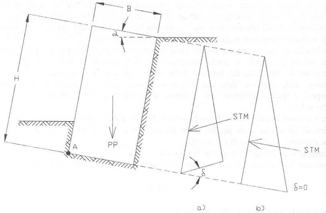
I risultati ottenuti (mediati fra le briglie di diversa altezza) sono sintetizzati nella seguente tabella, in cui sono riportati anche i **coefficienti di sicurezza al ribaltamento ( $FS_{rib}$ ) ed allo scivolamento ( $FS_{sciv}$ )** che si raggiungono in relazione al minimo rapporto **B/H** da adottare nelle varie situazioni considerate.
