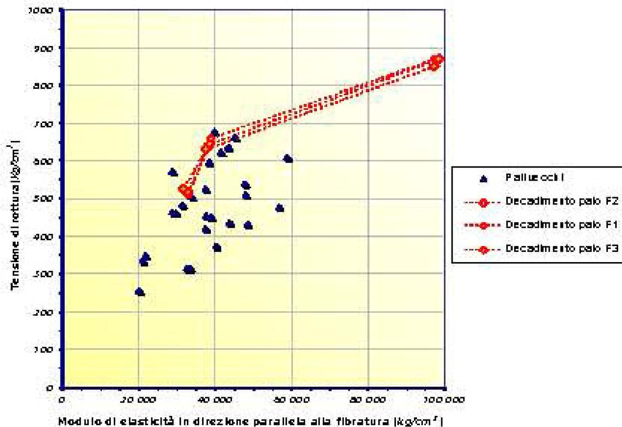
Figura 38 - Grafico delle tensioni di rottura.
