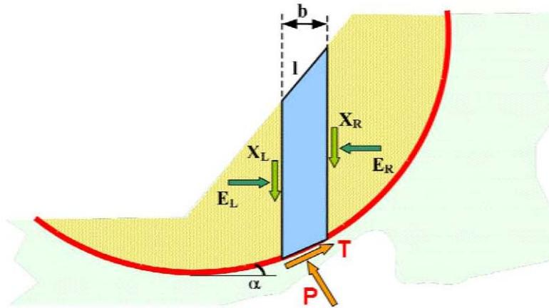
Figura 127 - Schema delle forze nel metodo di Bishop semplificato.
