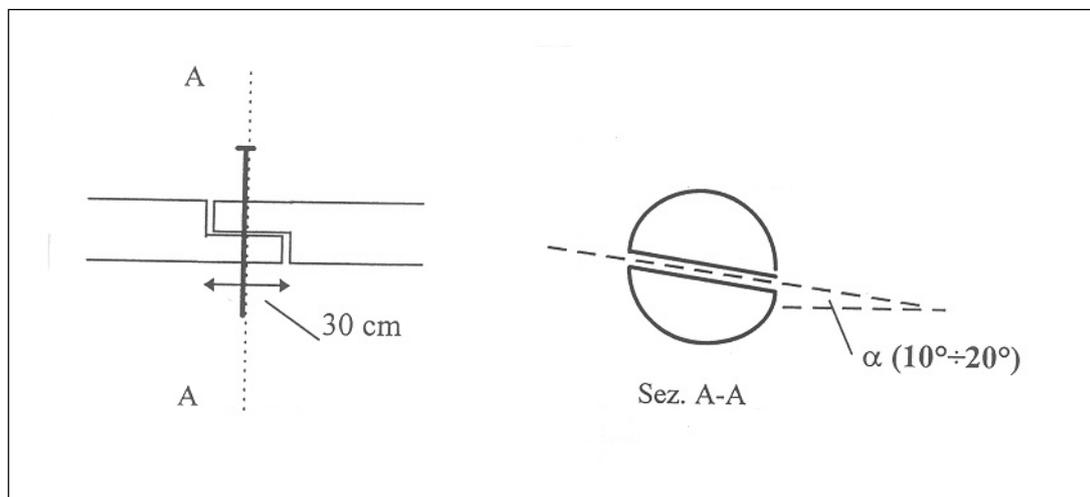
Figura 44 - Particolare del collegamento tra elementi longitudinali.
