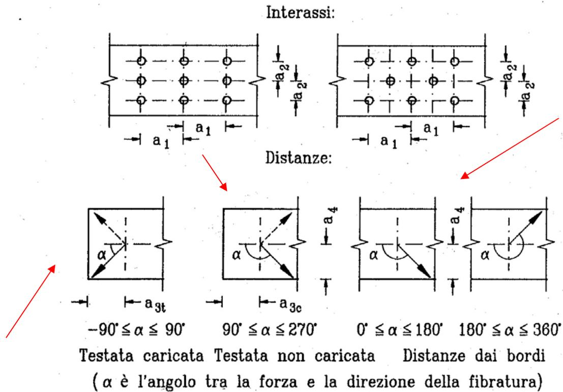
Figura 53 - Rappresentazione grafica degli interassi minimi ammessi e delle distanze minime ammissibili dei fori rispetto ai bordi in relazione alla fibratura del legno.
