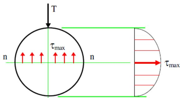
Figura 91 - Rappresentazione grafica delle tensioni di taglio.
