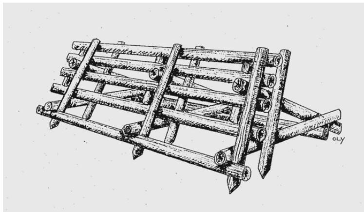
Figura 97 - Schema costruttivo della palificata Roma (a destra) e prospettiva di insieme della struttura della palificata Roma (a sinistra).
