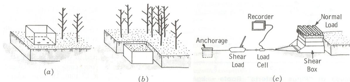
Figura 21 - Prove di taglio in situ su terreni radicati. (a) delimitazione del blocco di prova (b) scavo del blocco di prova (c) apparecchiature e schema di prova.
