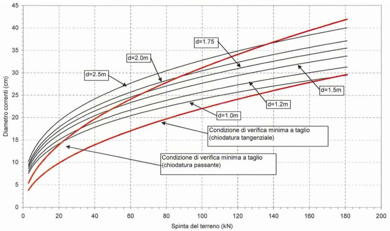
Figura 134 - Curva di minima verifica interna per la specie forestale di castagno  $\sigma = 900 \text{ N/cm}^2$  e  $\tau = 350 \text{ N/cm}^2$ .
