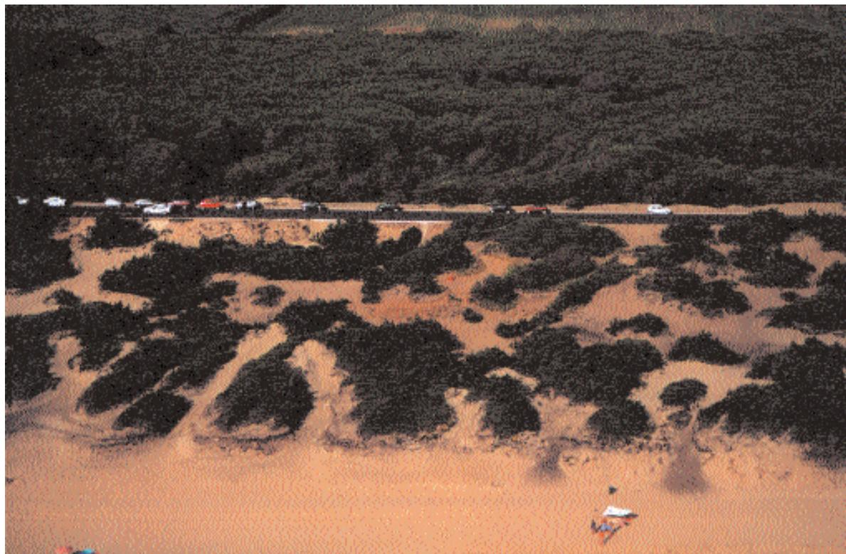
Foto 19.2.1 - Vista aerea della duna del Parco Nazionale del Circeo con i segni delle diverse forme di erosione in atto: marina, eolica, da calpestio e da ruscellamento
