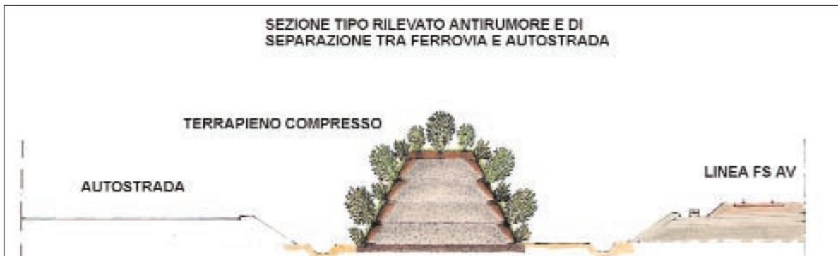
Fig. 18.15 - Terrapieno in doppia terra rinforzata rinverdita, in rete metallica zincata e plastificata
